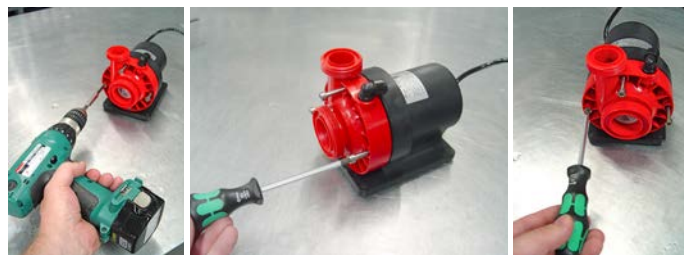
Mit passendem Inbuschlüssel die 4 Gehäuseschrauben ausdrehen.
