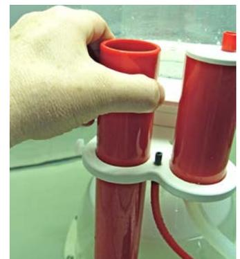
Am Rand des Keilrohrhalters, befindet sich eine kleine Schraube. Diese Schraube dient zum Klemmen des Keilrohres im Führungshalter.
