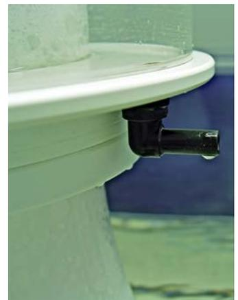
Dadurch wird ein Auffüllen des Schaumbechers, mit festem, trockenem Schaum, verhindert, da die Blasen bei Berührung mit Fetten, sofort platzen. So sammelt sich im Absorbatopf nur abgeschäumtes Absorbat und kein fester Schaum der u.U. aus den Topf-Entgasungslöchern treten könnte.
