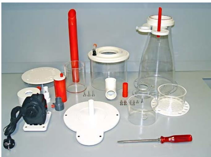
Bitte entfernen Sie alle abbaubaren Teile wie Keilrohr, Topf, Schläuche, Pumpe und nehmen auch das T-Stück vom Auslauf, aus seinem Sitz. Alle Titanschrauben sind zu entfernen. Das rote Rohr für die Eindüsung, mit spitzer Zange herausziehen.
