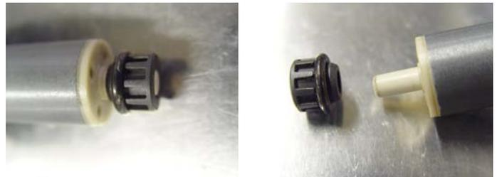
Sollte die hintere Lagerbuchse, wie auf dem Abbildung beim rausziehen der Läufergruppe, auf der Welle sitzen, ist das Lager unbedingt von der Welle zu entfernen. Auf den folgenden Abbildungen ist zu sehen, wie die Gleitlagerbuchse eingesetzt wird.
