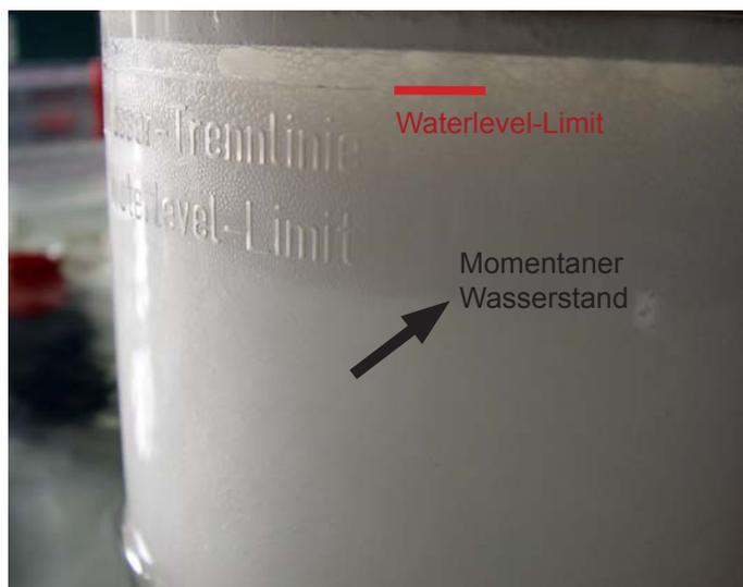
In der Abbildung oben (*Wasserstandstrennlinie*) ist die Wasserstandstrennlinie, ca. 10cm unter der Höchstmarke erkennbar. Sollte der Abschäumer ausreichend trockenen Schaum produzieren, ist es empfehlenswert, am äußerem Ende des Steigrohres, dieses einzufetten, ebenfalls den inneren Schaumring.
